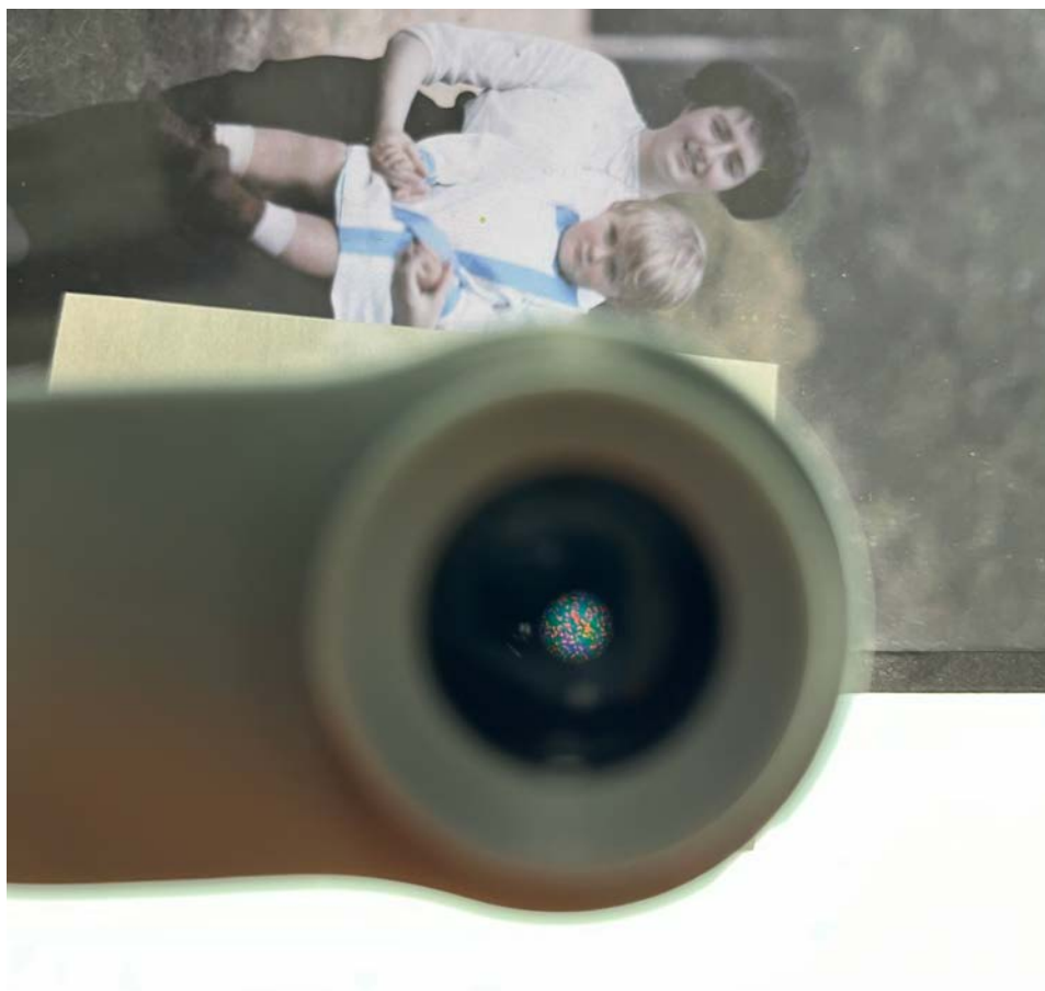
Figura 2. Identificarea procesului fotografic cu ajutorul unui microscop Carson MicroBrite Plus 60-120x LED
